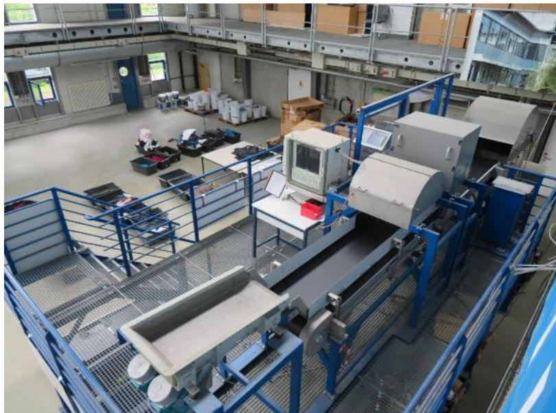
Abbildung 5-3: Zuführtransportband, Detektionseinheit und Monitor der NIR-Anlage
