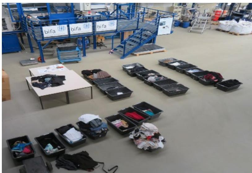
Abbildung 5-4: Sortierstation, NIR-Anlage und Materialfraktionen
