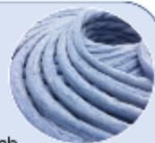
Naturfasern liegen als Stapelfasern vor, d.h. die einzelnen Fasern haben eine endliche Länge. Synthetisch hergestellte Fasern sind entweder endlose Filamente oder werden ebenfalls zu Stapelfasern verarbeitet. Die kurzen Fasern werden in vielen Prozessschritten zunächst parallelisiert, dem Kardieren oder bei Wolle auch Krempeln genannt, bis sie zu einem losen Faserkörper mit geordneten Einzelfasern, dem Band, gestreckt werden.
