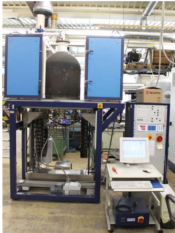
Abbildung 7-10: Haubenofen für Vakuum- und Schutzgasbetrieb
