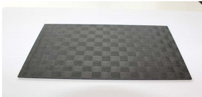
Abbildung 7-20: Pyrolyseplatte für Einzelfaserzugversuche (150 mm x 100 mm x 2 mm)
