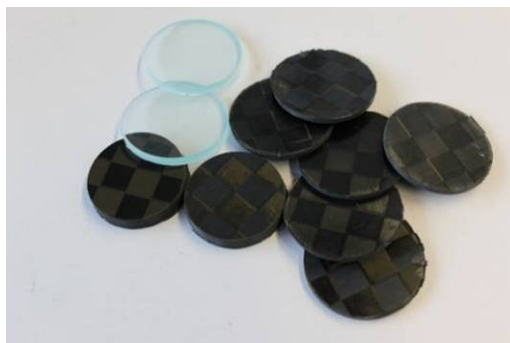
Abbildung 7-3: Probekörper für die Thermogravimetrische Analyse
