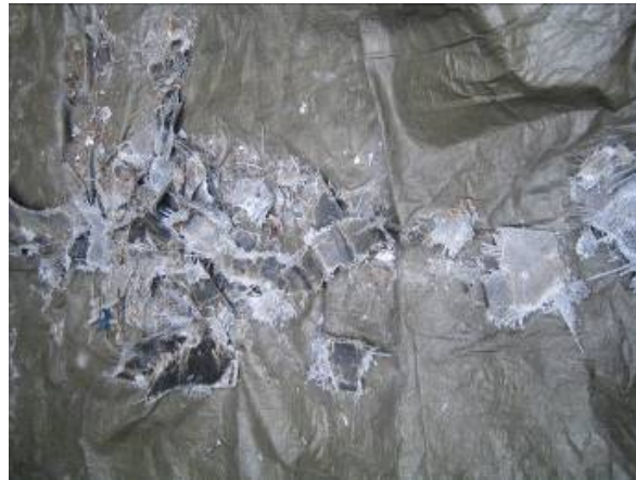
Abbildung 9-1: Im MPA-Shredder zerkleinertes CFK-Bauteil
