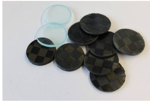
Abbildung 7-15: Probekörper für die Thermogravimetrische Analyse
