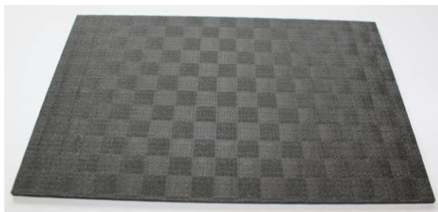
Abbildung 7-5: Pyrolyseplatte für Einzelfaserzugversuche
