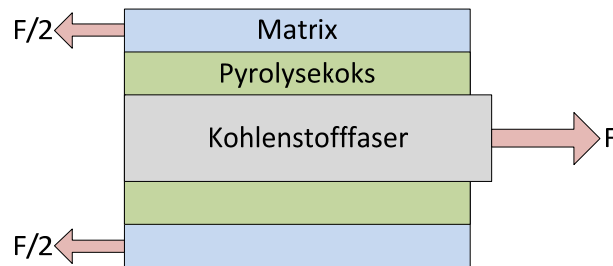
Abbildung 7-37: Pyrolysekoks auf rC-Faser
