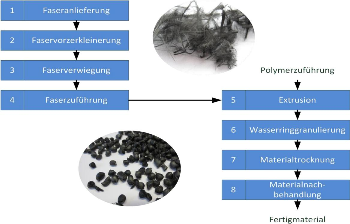
Abbildung 6-35: Prozesskette Carbon Compounding bei WIPAG
