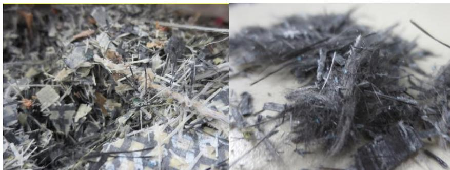
Abbildung 6-15: *Inputmaterial geschreddert und nach Zerkleinerung per Mühle*
