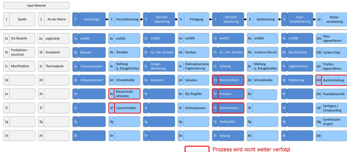
Abbildung 6-36: Prozessbaukasten zur stofflichen Verwertung von CFK-Material
