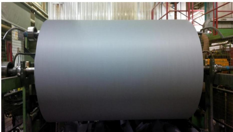
*Abbildung 6-33: Im Rahmen des Großversuchs bei Neenah-Gesner aus Pyrloysefasern hergestelltes carbonfaserhaltiges Papier (Foto: Neenah-Gessner)*
