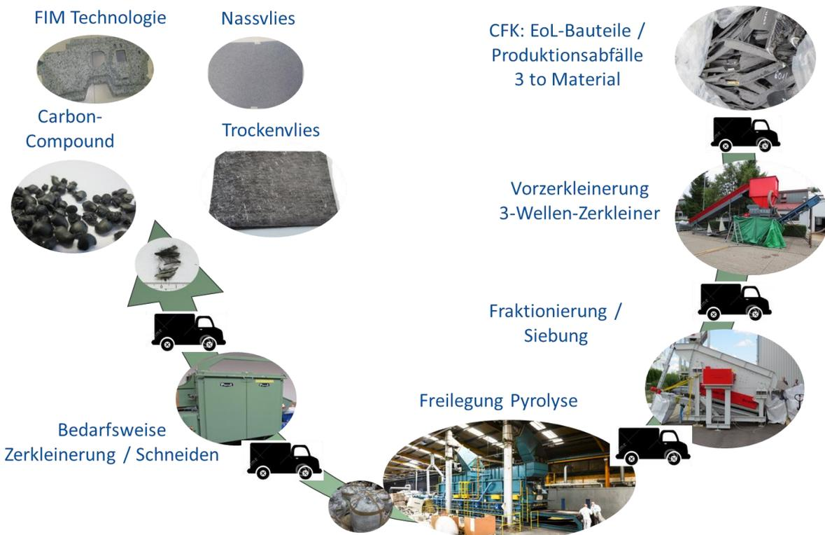
Abbildung 6-23: Prozesskette Großversuch (Quelle für Abbildung zur Pyrolyse: ELG Carbon Fibre Ltd.)
