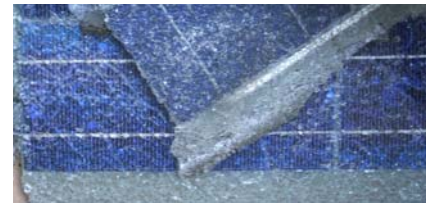
Angelieferte PV-Module (oben) und Module nach der Zerkleinerung (unten)
