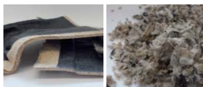
Verpresstes Naturfasermaterial: vor und nach der Zerkleinerung mit einer 3-Wellen-Maschine
