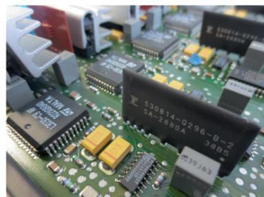
Nach der Erprobung unterschiedlicher manueller und automatisierter Methoden fiel die Entscheidung auf ein thermisches Verfahren: Die Leiterplatten werden erhitzt damit die Bestückungskomponenten schonend entfernt werden können. Die abgetrennte Bauteilmischung wird dann gesiebt und mit
