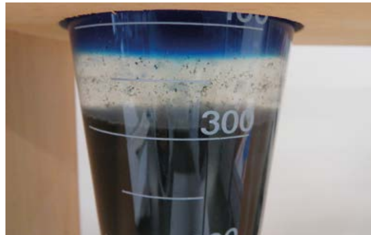
Abgesetzter Belebtschlamm im Imhoff-Trichter Klare Flüssigkeit: Sauerstoffarme Zone mit entfärbtem Redoxindikator (Methylenblau) Blaue Flüssigkeit: Sauerstoffhaltige Zone mit oxidiertem Redoxindikator
