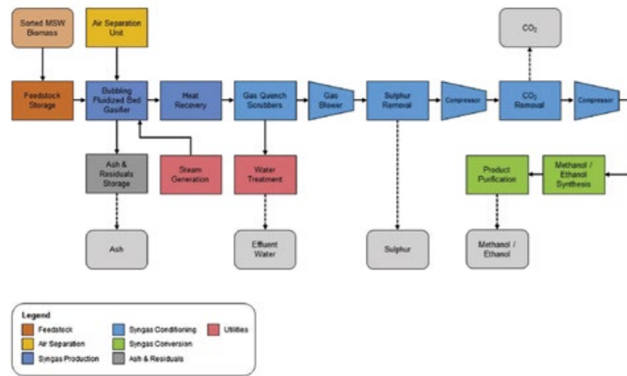
Abbildung 10: Schematische Darstellung des Enerkem-Verfahrens (Perkins 2020)
