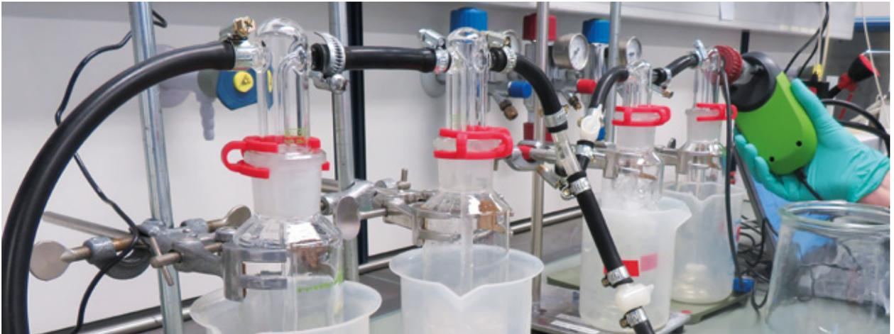
Messung der Prüfkeimlösung mit dem airco well® Sensor
