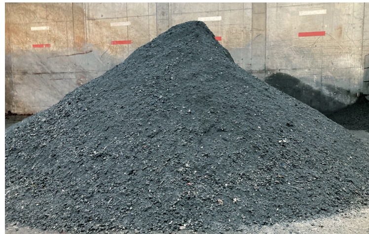
Mineralischer Restanteil der Rostasche nach Schlackeaufbereitung
