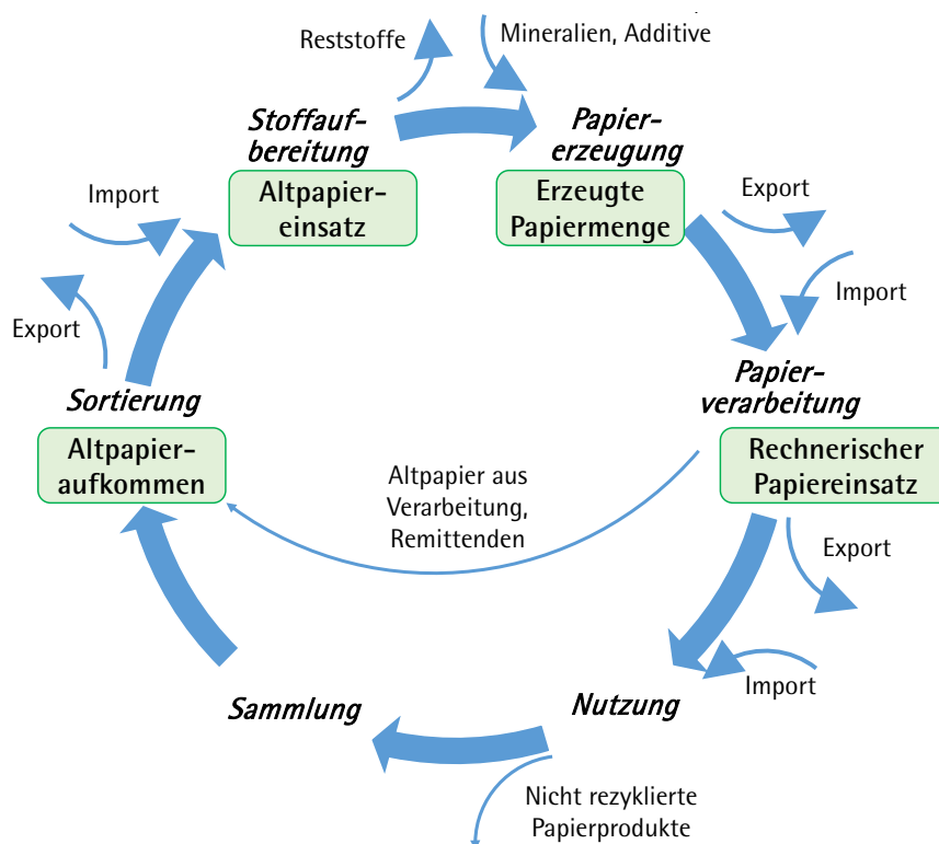
Abbildung 15 Der Papier-Altpapier-Kreislauf wie in Abbildung 2, ergänzt durch Bilanzpunkte, die für die Berechnung von Quoten maßgeblich sind.
