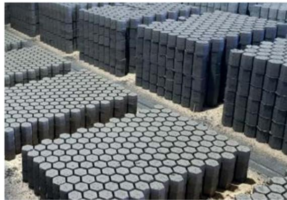
Gestapelte Presslinge bei der Serienproduktion
