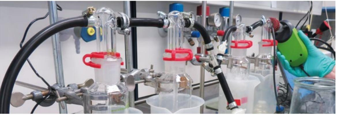
Messung der Prüfkeimlösung mit dem airco well® Sensor
