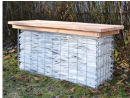
Tiegelscherben aus Quarzglas für dekorative Zwecke am Beispiel einer Sitzbank für Mitarbeiter am bifa Umweltinstitut.
